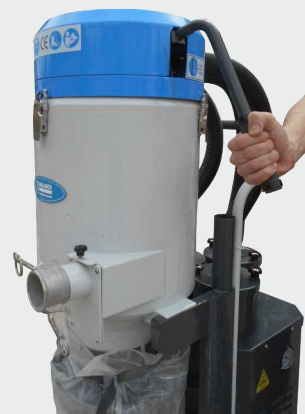
Пневматическая очистка фильтра
