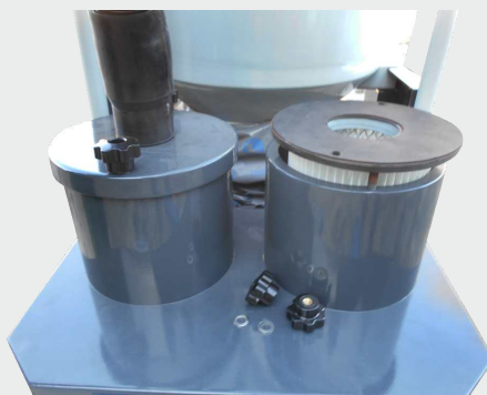
Фильтр 2-й ступени очистки
