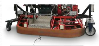
Возможна установка защитного фартука для предотвращения разбрызгивания
