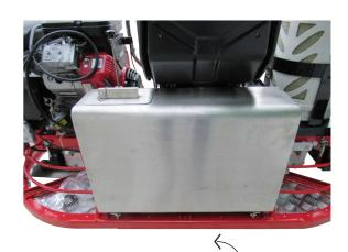
Большой бак для воды и спец. жидкостей на 100 л из нержавеющей стали позволяет увеличить продолжительность непрерывной работы
